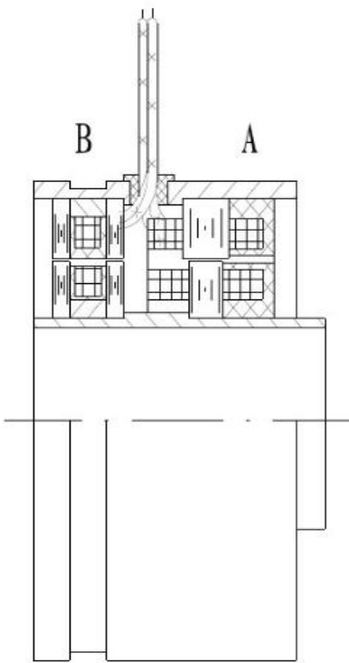
图 1、环形变压器式旋变结构示意图
